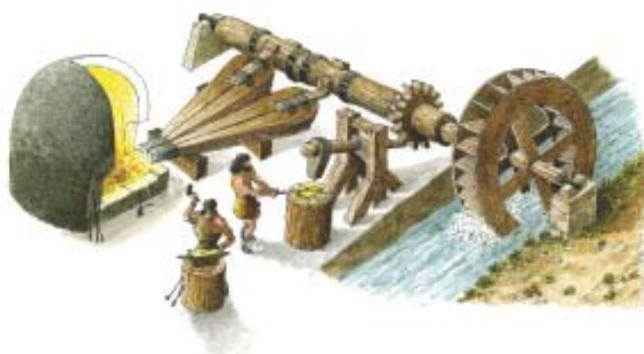
Fig 1: Fragua hidráulica. La fuerza del agua movía el martillo, facilitando la labor para elaborar todo tipo de herramienta
